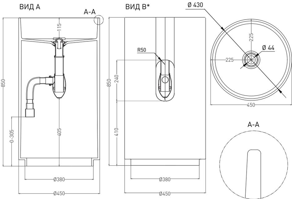
\* Расположение стандартного технического отверстия на задней стенке. В базовую комплектацию не входит, заказывается отдельно.
